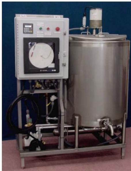
Figura 2 – Pasteurizador tipo LTLT acoplado a equipamento de registro e controle de temperatura.
