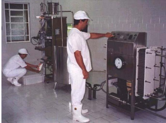
Figura 1– Pasteurizador tipo HTST acoplado a equipamento de registro e controle de temperatura.
