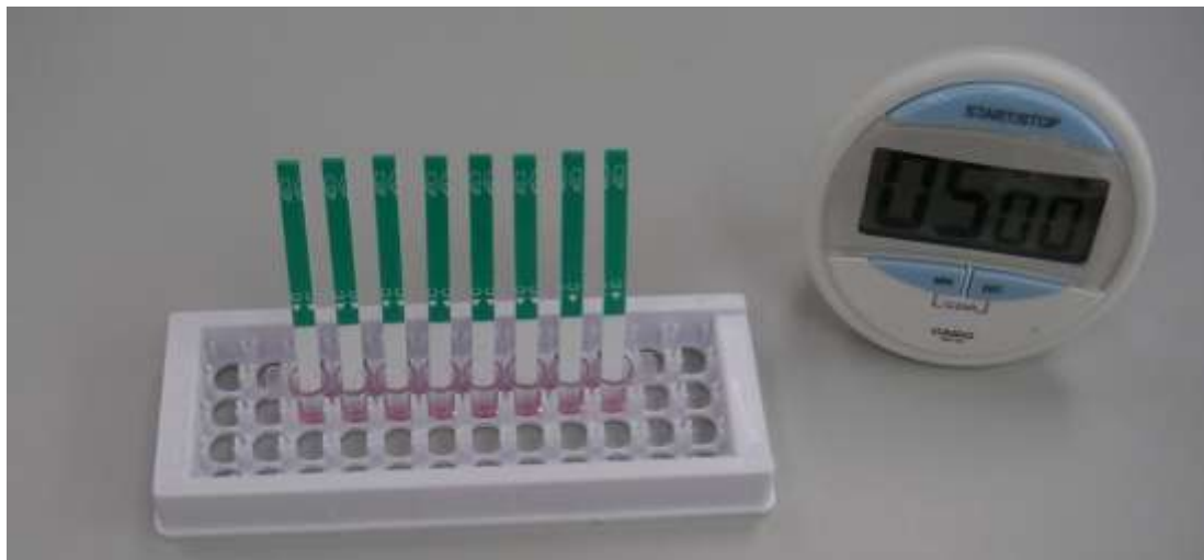
Figura 3 – Micropoços com as fitas testes para aflatoxina (Cortesia Romer Labs do Brasil).
