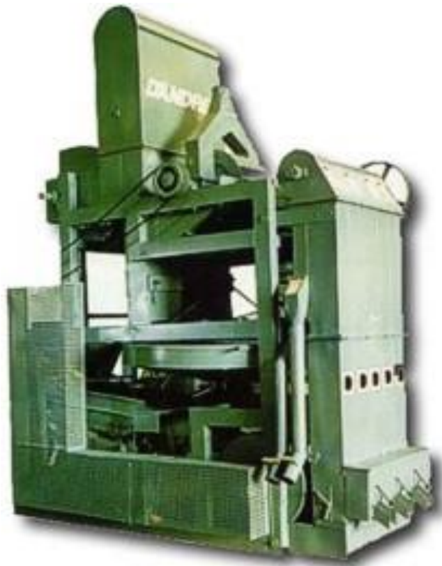
Figura 10 – Equipamento de rebenefício de café com múltipla função.
