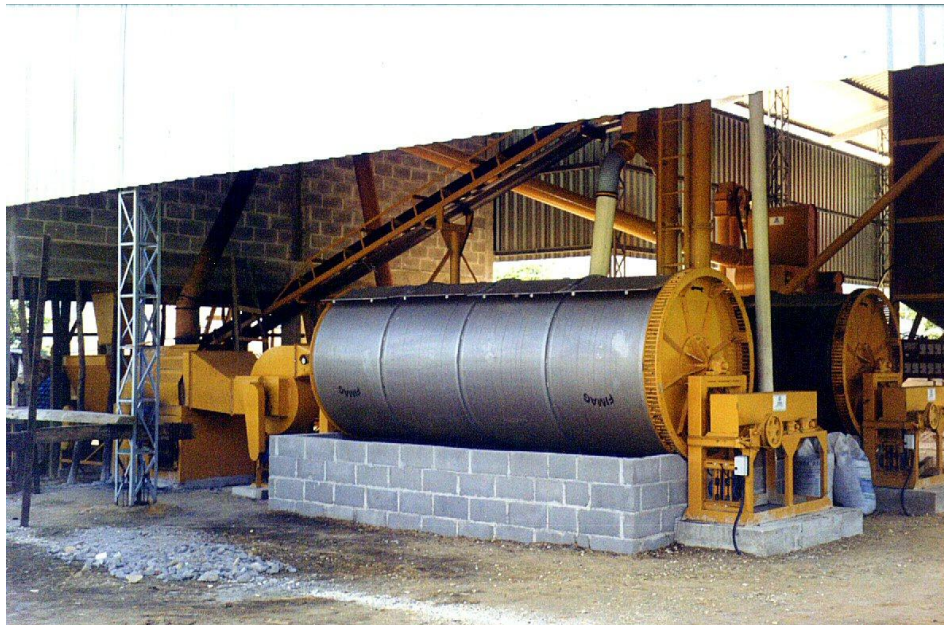
Figura 4 – Secador rotativo de fogo indireto
