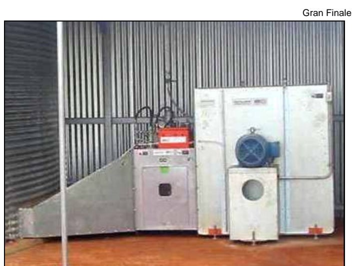
Figura 7 – Conjunto: ventilador e queimador de gás utilizados em secadores ao nível de fazenda (Gentileza da Gran Finale)
