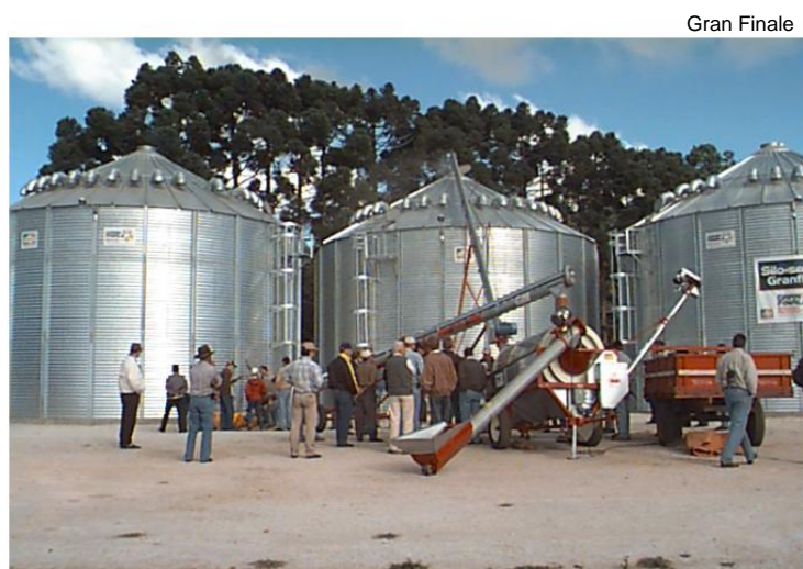
Figura 8 – Sistema de armazenagem ao nível de fazenda. Ao centro o silo secador, nas laterais os silos armazenadores (Gentileza da Gran Finale)
